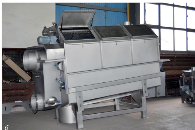
Фильтры для очистки пищевой жидкости (пульполовушки) из нержавеющей стали: а – LB90-300; б – LB-1230
